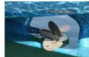
2.2. L'énergie électrique produite par l'hydrogénérateur dépend de la vitesse de navigation du voilier.
